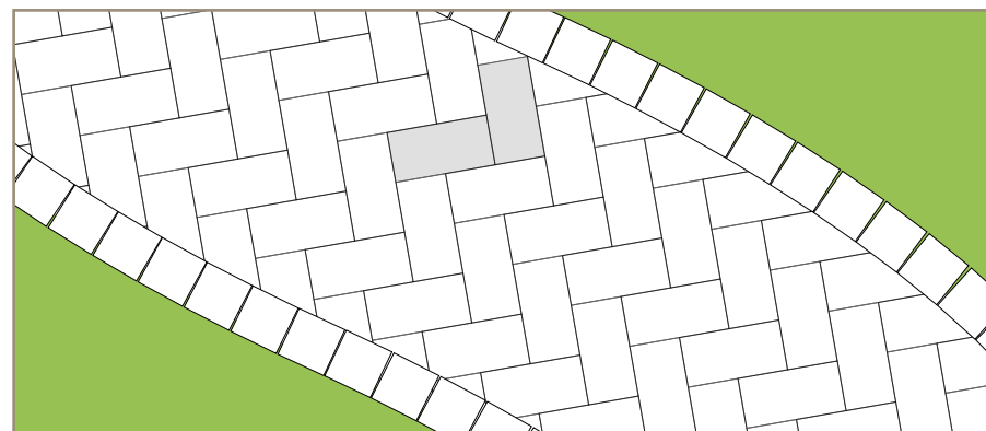
Walkway with L-shaped element at the edge. Composizione vialetto con Elemento L al bordo.
