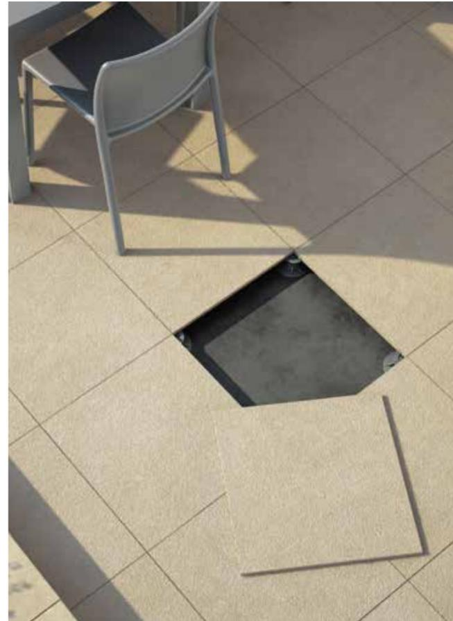
Die Doppelböden für Außenbereiche werden vor allem auf eher großen, regelmäßigen Oberflächen oder über alten Fußböden verwendet, insofern diese keine Spuren von eingesickertem Wasser aufweisen. Dank den offenen Fugen zwischen den Platten kann das Regenwasser in den Zwischenraum sickern, der unter den Platten entsteht. So erhält man einen ebenen Fußboden, während der undurchlässige Teil darunter alle notwendigen Neigungen aufweist, damit das Regenwasser abgeleitet werden kann.
