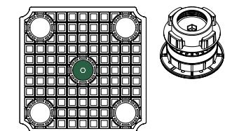
AL FINE DI GARANTIRE LA PERMEABILITÀ ALL'ACQUA DEL SISTEMA, SI RACCOMANDA L'UTILIZZO DI UN GEOTESSUTO CON GRAMMATURA MASSIMA DI 50 G/MQ.
