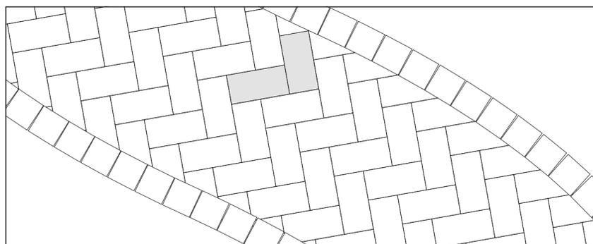
Composizione vialetto con Elemento L al bordo - Walkway with L-shaped element at the edge
